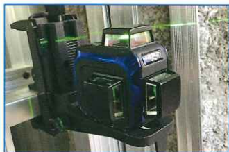
昇降機能付クランプで壁面、銅材(H鋼)、軽量鉄骨等に設置可能
