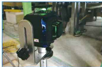
マグネット付L字金具でレーザー用三脚(5/8インチ)に取付可能
